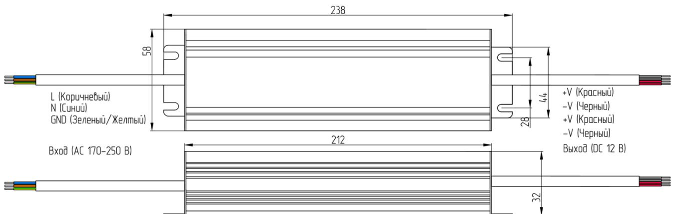
Рисунок 2 – Габаритный чертеж.
